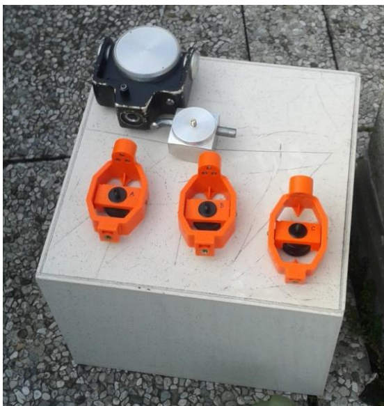
Slika 16: precizni reflektor WILD GPH1P (zgoraj), jekleni nastavek (na sredini), mini reflektorji GMP 111 (spodaj)
