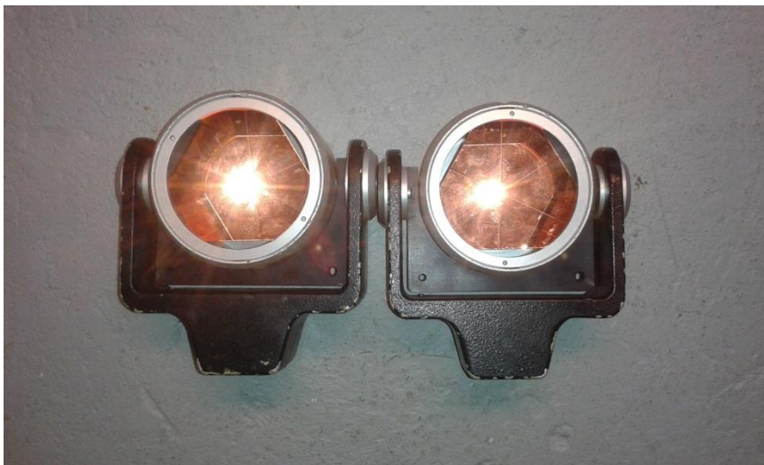
Slika 19: Precizna reflektorja WILD GPH1P (reflektor 1 in 2 sta enaka) (osebni arhiv)
