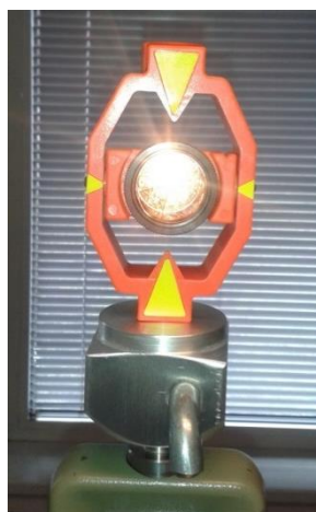
Slika 17: Slika mini reflektorja GMP 111 na jeklenem nastavku
