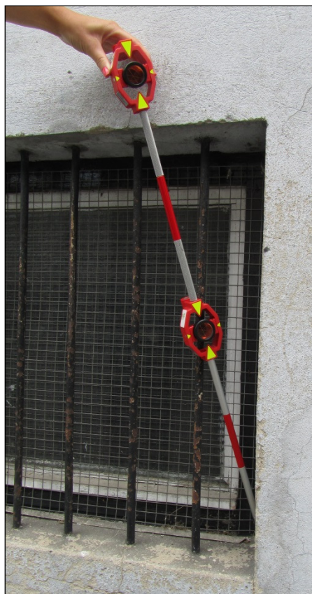
Slika 27: Uporabljen komplet dveh reflektorjev za merjenje skritih točk
