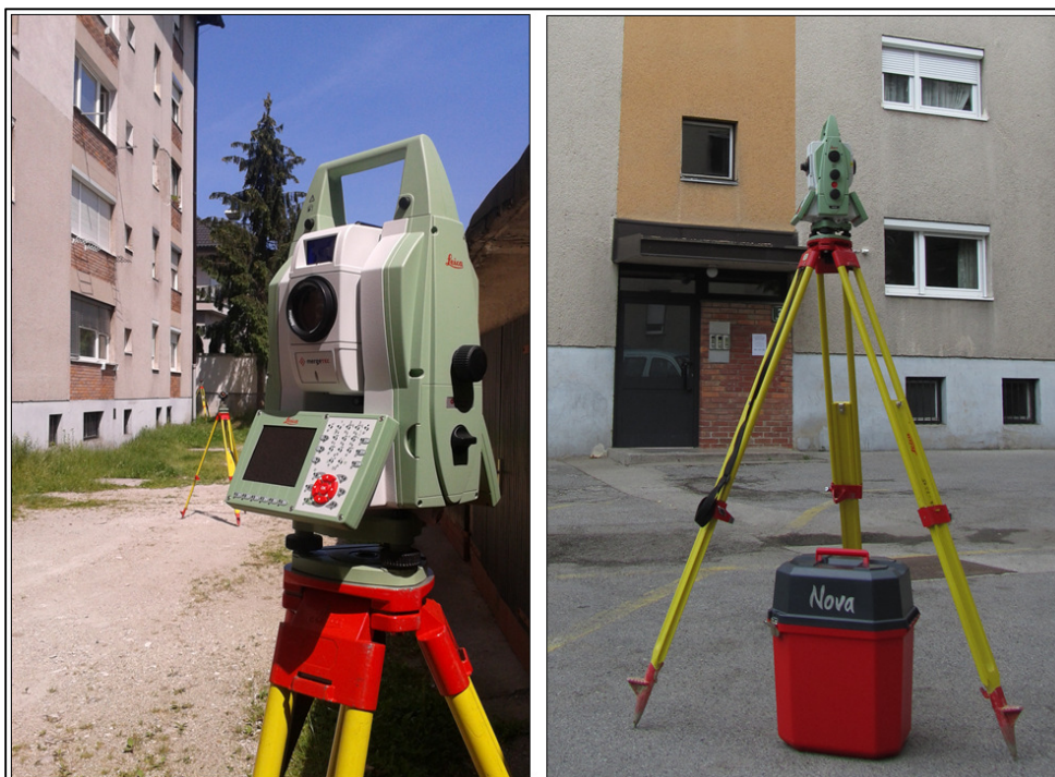
Slika 22: Uporabljen instrument Leica Nova MS50 MultiStation
