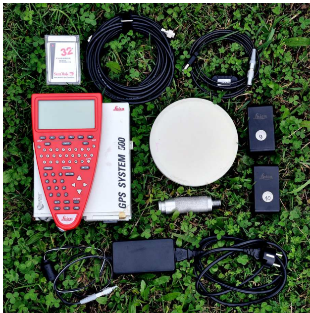
Slika 9: Komplet opreme za izvedbo statične izmere GNSS in vzpostavitev stalno delujoče referenčne postaje
