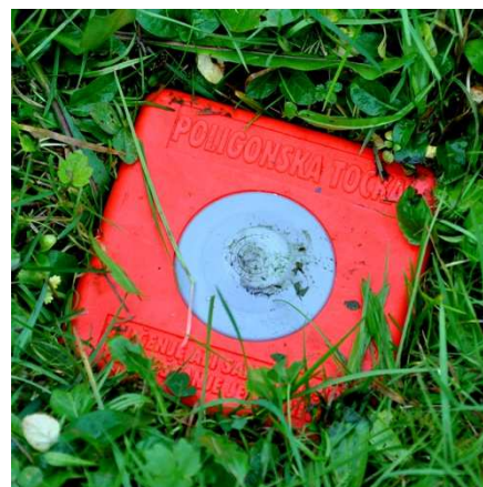
Slika 8: Stabilizirana kontrolna točka
