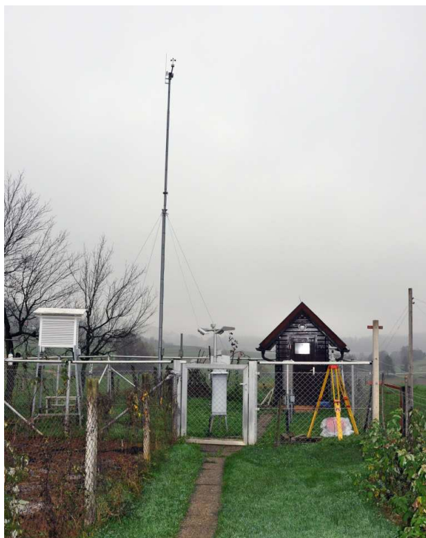
Slika 11: Izvedba statičnih opazovanj na točki Dobliče
