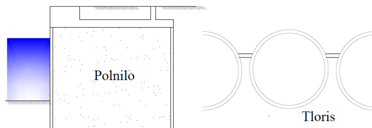
Slika 4: Celična stena (CUR, 2005: str. 75)
