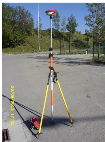
Slika 8: GPS sprejemnik RX900CSC, dvonožnik, trasirka.
