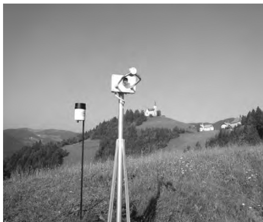
Slika 12: Disdrometer Thies Clima in avtomatični dežemer na Črnem Vrh nad Polhovim Gradcem Figure 12: Disdrometer Thies Clima and tipping bucket rain gauge in Črni Vrh nad Polhovim Gradcem
