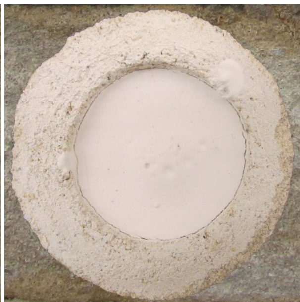
Slika M.3: Testiranje injekcijske mešanice L_1 S_2 B_1 PCE na terenu – tečenje na apnenih ploščah in prostorninska stabilnost z apnenimi skodelicami.
