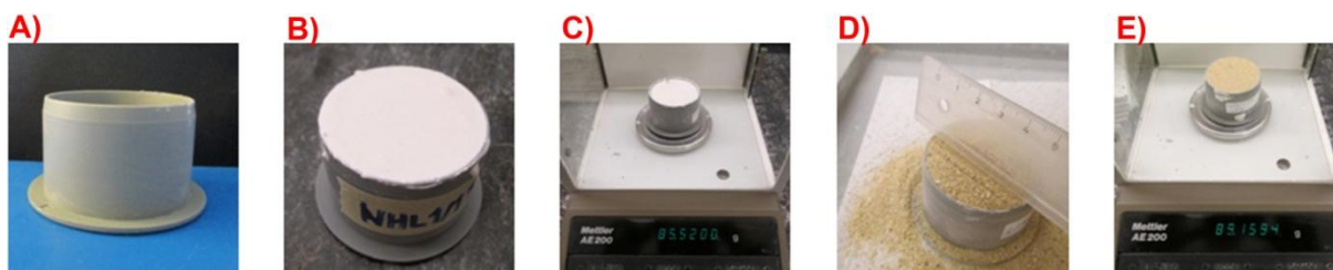
Slika 3.5: Prikaz določanja spremembe prostornine mešanice zaradi krčenja s plastičnimi cilindričnimi kalupi: A) prazen kalup; B) kalup, napolnjen z mešanico; C) tehtanje strjene mešanice; D) prazen volumen napolnimo s peskom; E) kalup z mešanico in peskom stehtamo.
