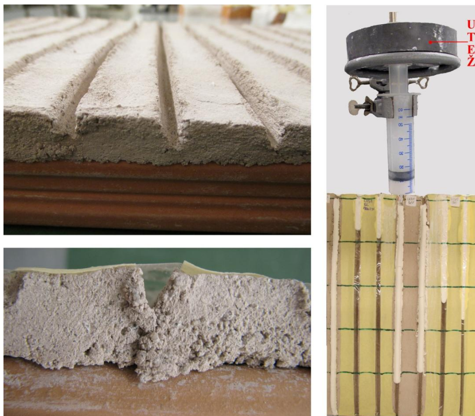
Slika 3.8: Plošča z odprtimi (levo zgoraj) in zaprtim kanalčkom (levo spodaj) V-oblike. Injiciranje mešanice v kanalček s pomočjo uteži na injekcijskem batu (desno).
