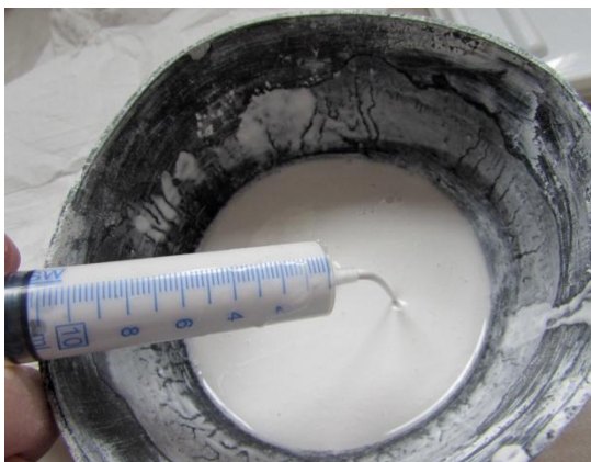
Slika 4.1: Kvalitativni test z injekcijsko brizgo za preverjanje injektabilnosti mešanice. Figure 4.1: Qualitative test of injectability of grout mixture with syringe.
