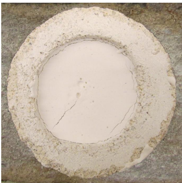
Slika M.3: Testiranje injekcijske mešanice L_1 S_2 B_1 PCE na terenu – tečenje na apnenih ploščah in prostorninska stabilnost z apnenimi skodelicami.
