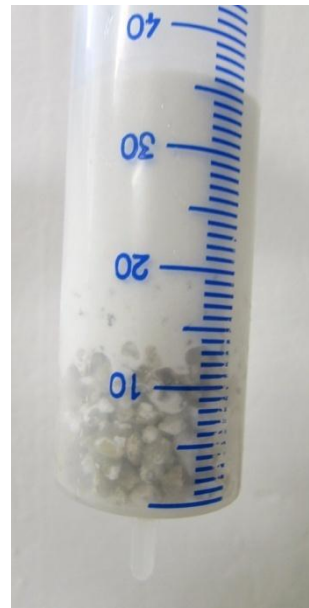
Slika M.2: Testiranje injekcijske mešanice L 1 S 2 B 1 PCE na terenu – injektibilnost in pretočnost z injekcijsko brizgo.
