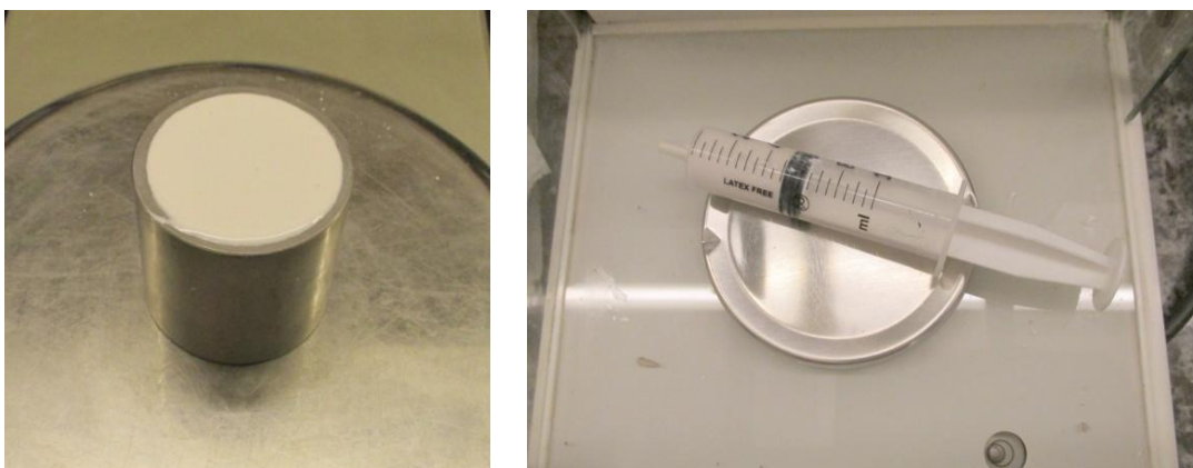
Slika 4.8: Cilindrična posoda, napolnjena z injekcijsko mešanico (levo). Injekcijska brizga, napolnjena z injekcijsko mešanico (desno).
