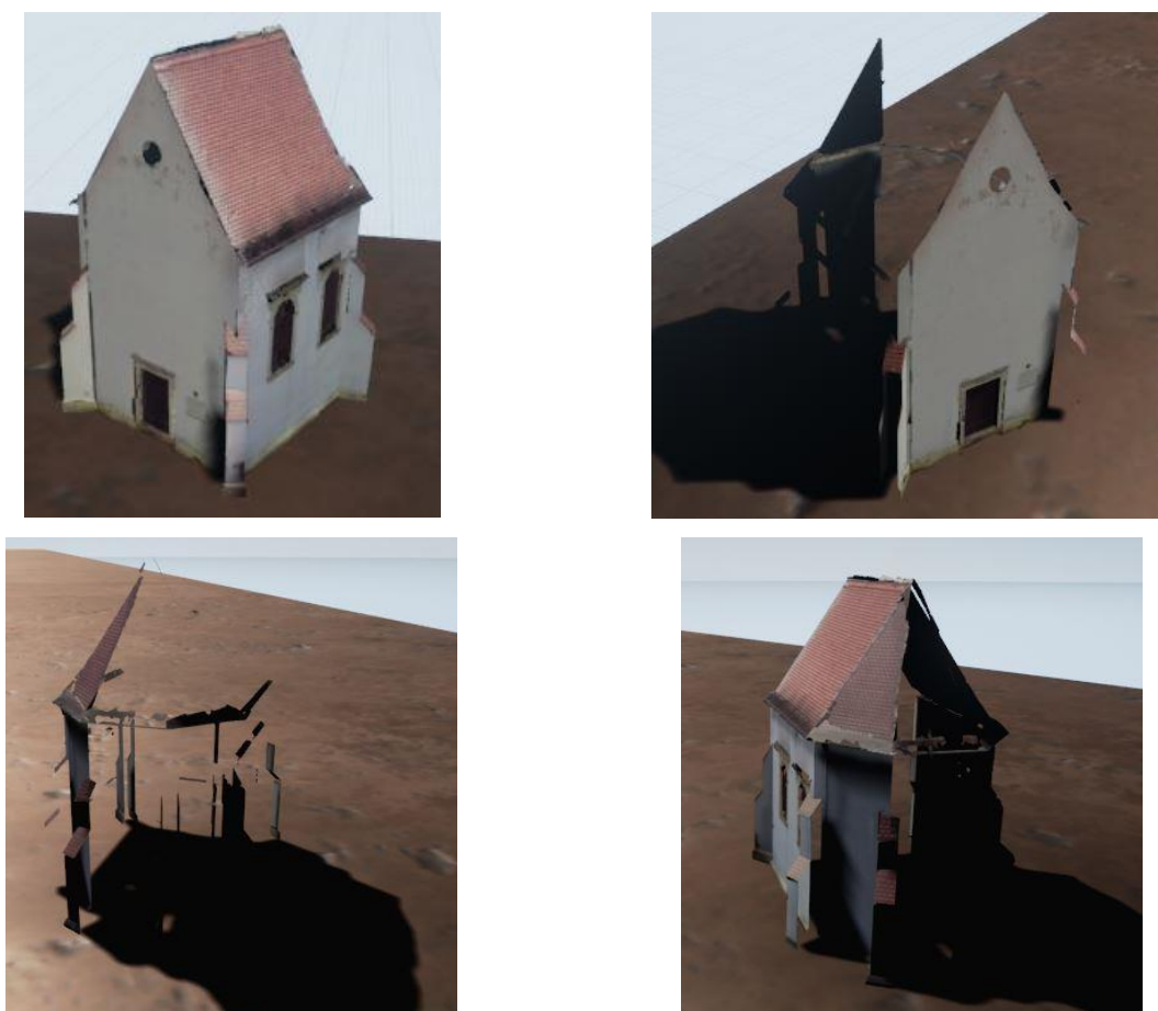
Slika 50: Težava z modelom, izdelanim v programu Pointfuse, brez izračunanih normal
