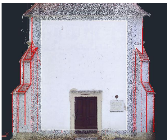
Slika 43: Ortografija na modelu, ustvarjena iz oblaka točk
