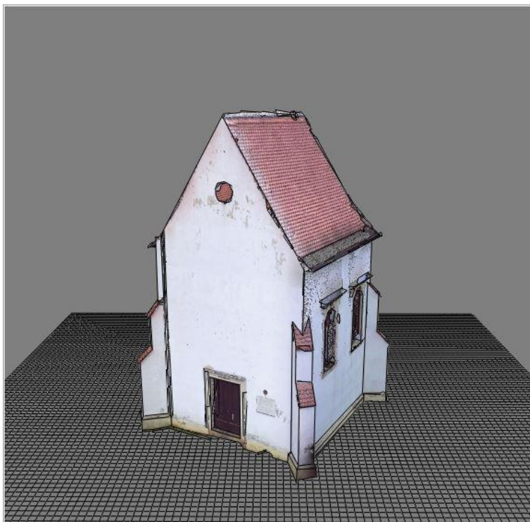
Slika 49: Končni model z realističnimi teksturami, pridobljen v programu Pointfuse
