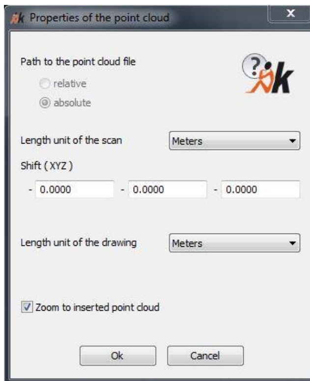
Slika 28: Nastavitve uvoza oblaka točk v AutoCAD
