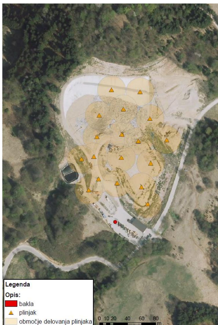
Slika 11: Prikaz razporeditve plinjakov na območju odlagališčnega telesa ([6], stran 30)
