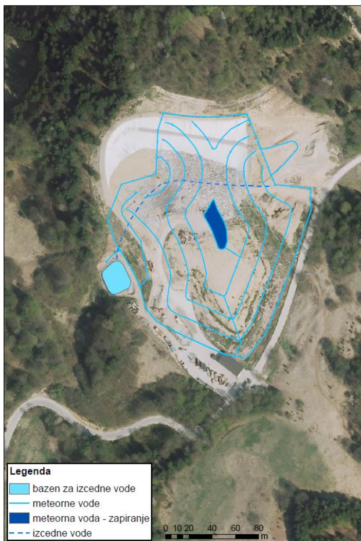
Slika 12: Prikaz odvajanja izcedne in meteorne vode iz odlagališča ([6], stran 32)
