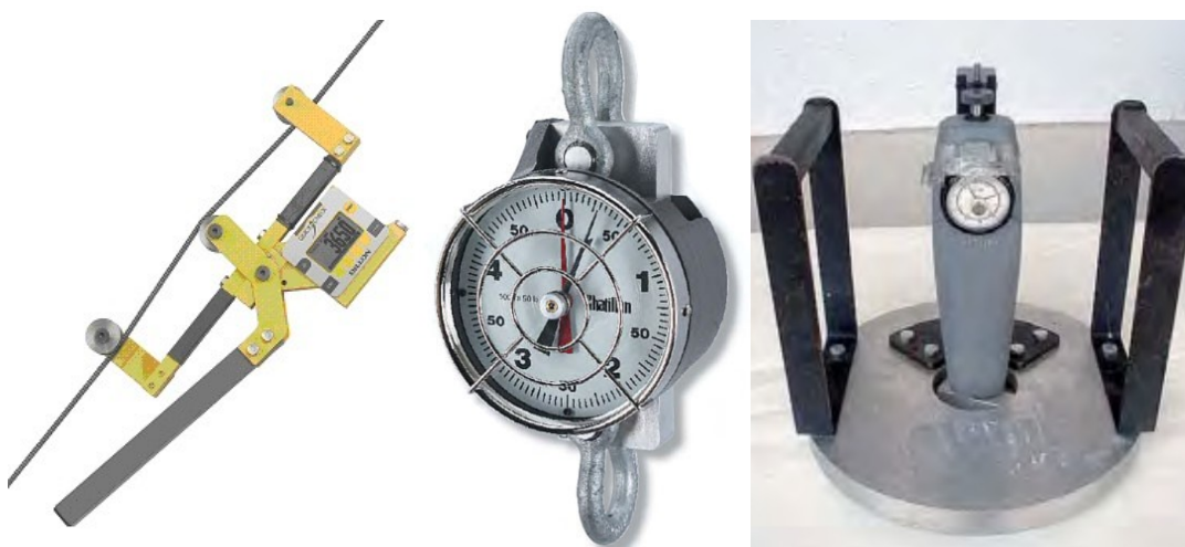
Slika 101: Tritočkovni merilec (levo) (Dillon/Quality, 2015) in dinamometer (na sredini) (Balances-Online.com , 2015) za merjenje sil v kablu. Ugrezni bat za merjenje napetosti v membrani (desno) (Seidel, 2009)
