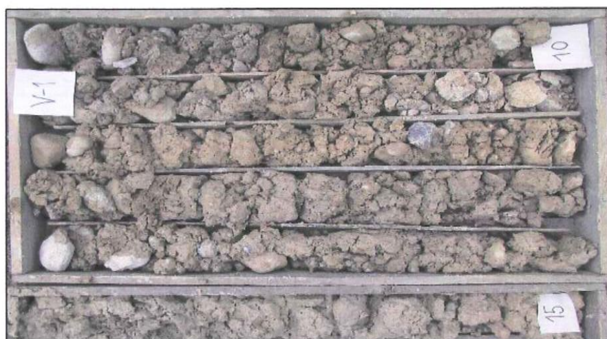
Slika : Raziskovalna vrtna V1 (vir: Geotehnično poročilo Črpališče fekalne kanalizacije na Savski cesti v Kranju, Gracen, d.o.o, april 2009)
