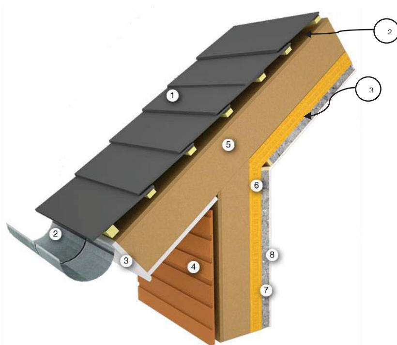
Slika 25: Konstrukcijski sklop strehe in stene [14]
