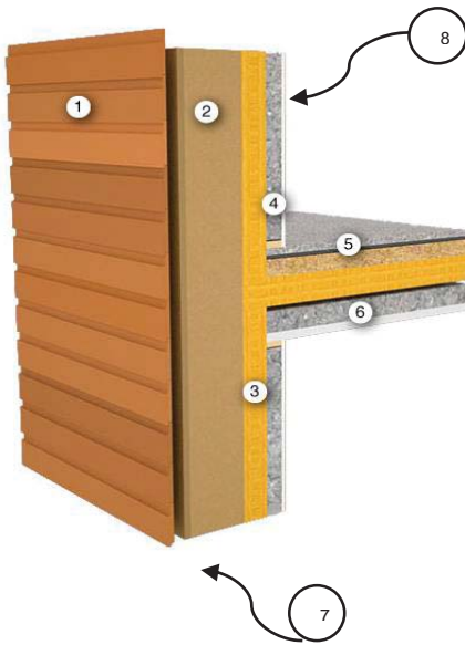
Slika 24: Konstrukcijski sklop zunanje stene [14]
