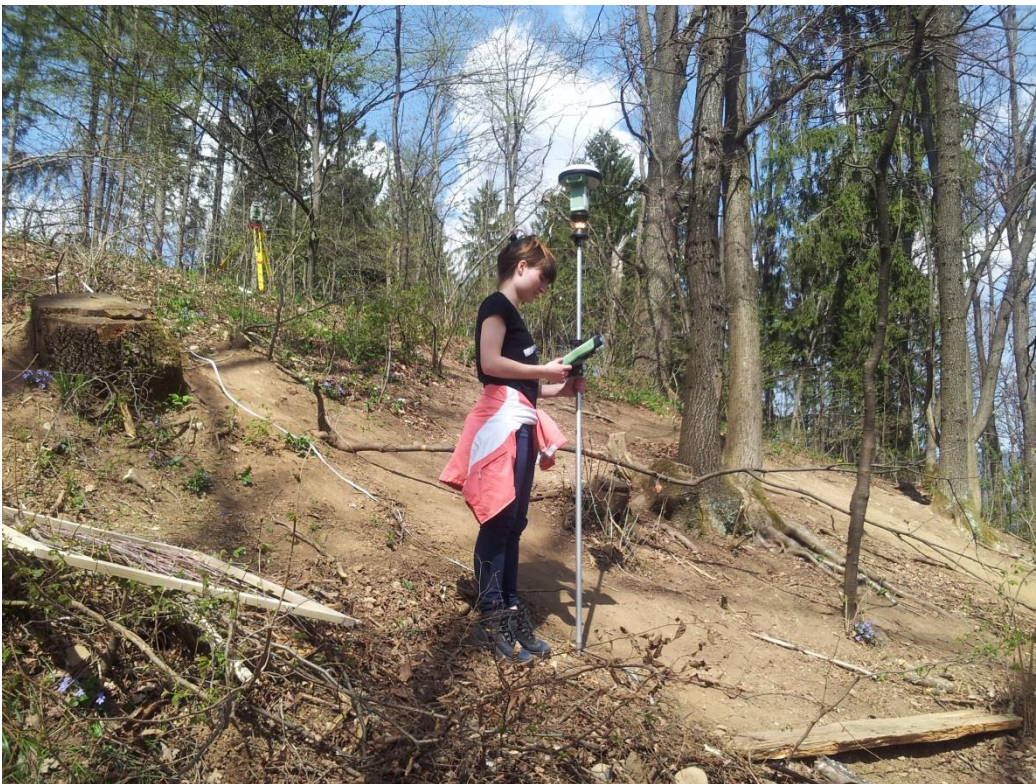
Slika 6: Kombinacija meritev z GNSS in elektronskim tahimetrom (delovišče B).
