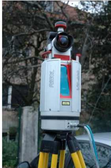
Slika 24. Laserski skener s pritrjenim digitalnim fotoaparatom (Hostnik, 2013)
