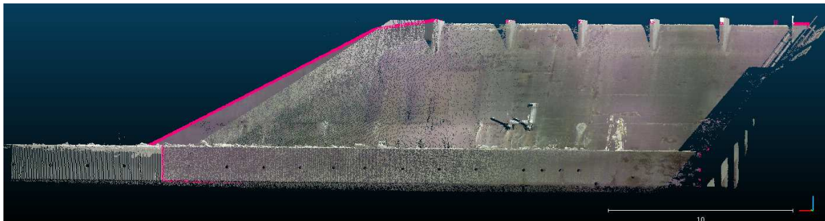
Slika 34. Združeni skenogrami iz stojišč O1, O2 in S2 v prvi terminski izmeri dne 21. 04. 2015.
