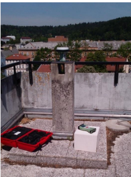
Slika 3: Sprejemnik GNSS, postavljen na točki FGG1
