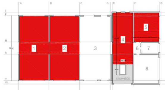
Slika 11: Kritična postavitev obtežbe za izračun minimalnih momentov nad podporo med poljema 1 in 2 ter 4 in 5
