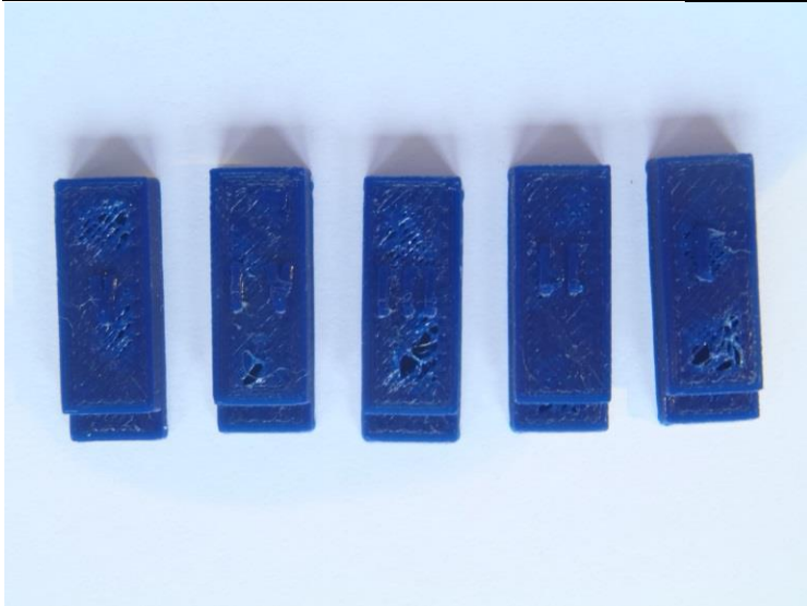
Slika 38: Vzorci pri hitrosti 60 mm/s in 20% zapolnitvi
