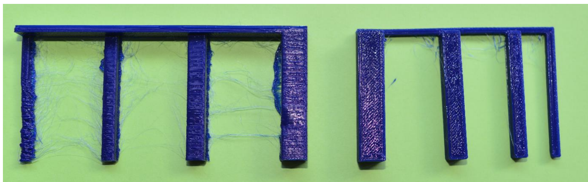
Slika 3: Levo natisnjeno vertikalno, desno natisnjeno horizontalno
