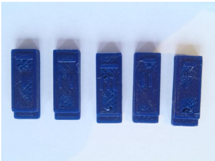
Slika 39: Vzorci pri hitrosti 15 mm/s in 20% zapolnitvi
