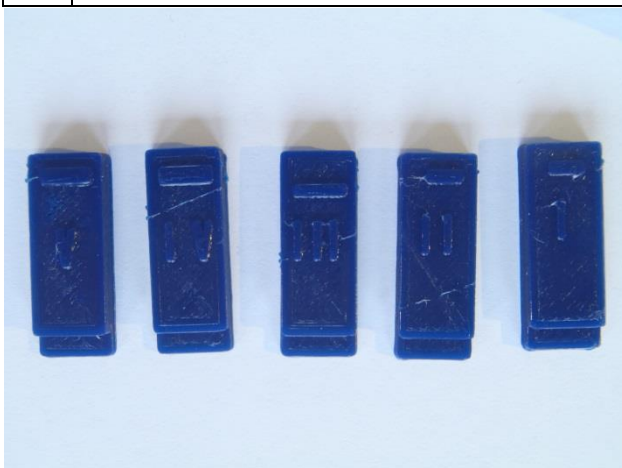
Slika 40: Vzorci pri hitrosti 15 mm/s in 40% zapolnitvi
