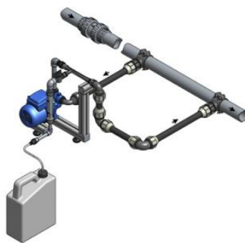
Slika 10: Venturi injektor z dodatno črpalko ter rezervoar za hranila (NETAFIM, 2014a)
