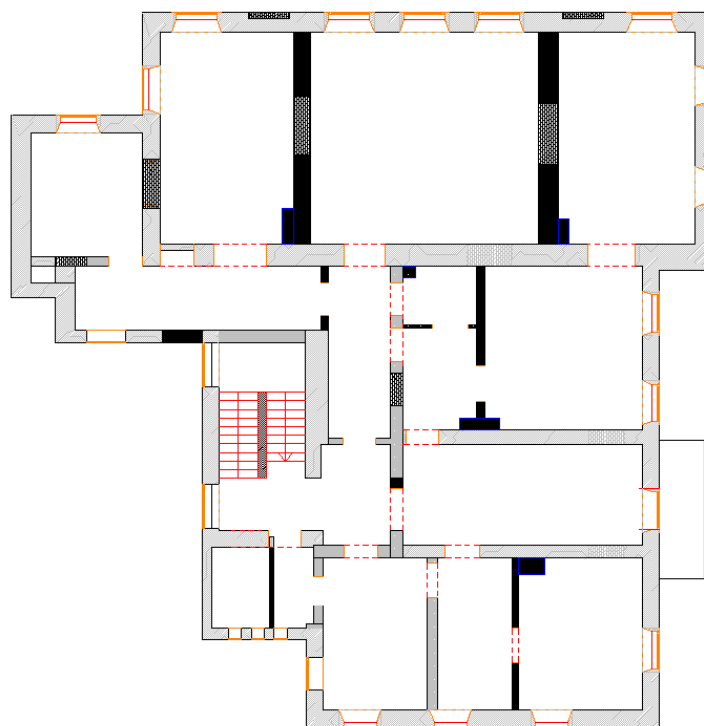
Slika 16: Tloris drugega nadstropja z označenimi rušitvenimi posegi (Poles, 2008)
