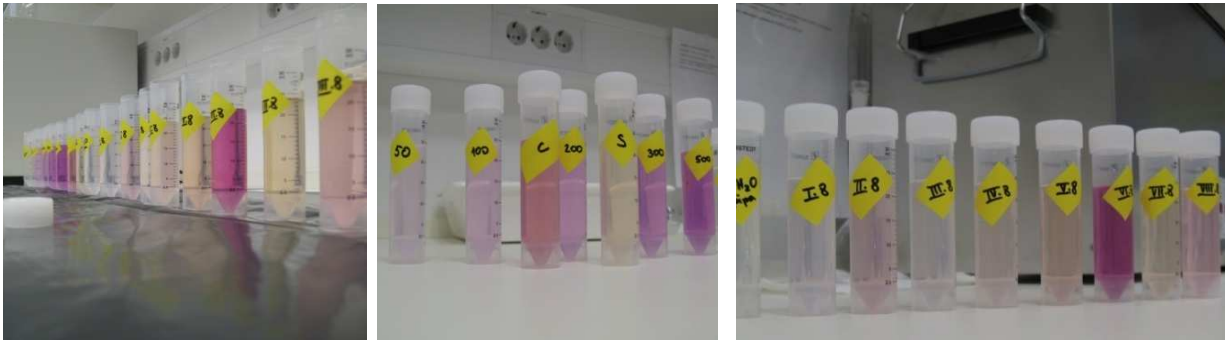
Slika 3.4: Priprava vzorcev za merjenje Cr(VI) s spektrofotometrično metodo.
