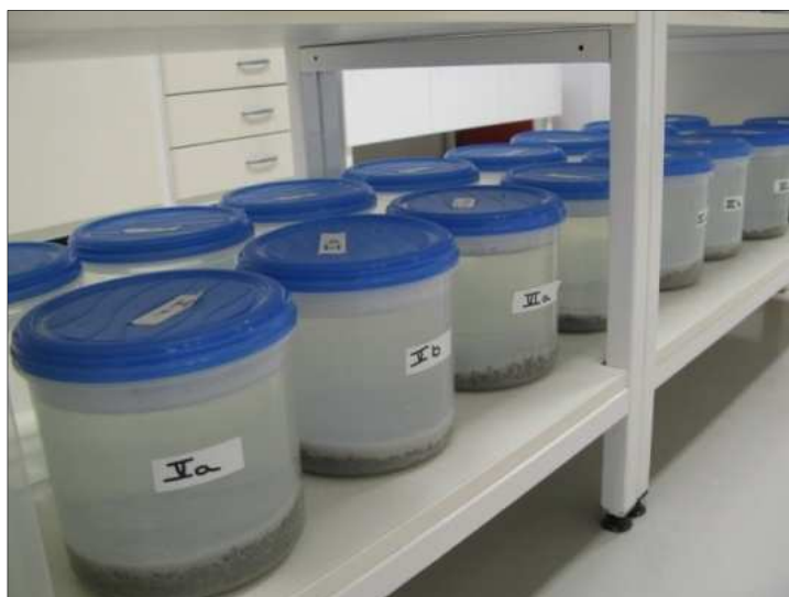
Slika 3.2: Polietilenske posode s preizkušanci med dolgoročnim izlužitvenim testom.
