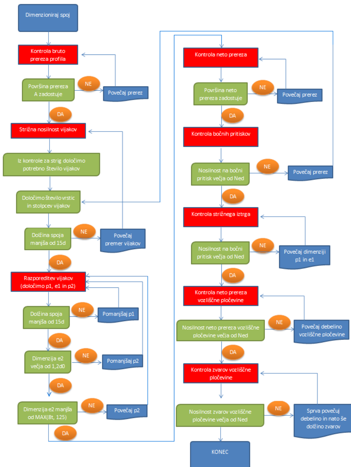
Slika 42: Shema makroja za dimenzioniranje komponente 11
