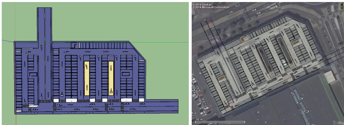
Slika 54: Tloris pritličja izdelan s programom SketchUp (levo v programu SketchUp, desno izvoženo v program Vissim).
