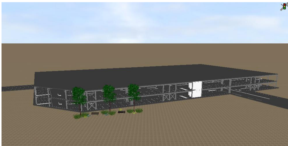
Slika 57: 3D model parkirne hiše izdelan s programom SketchUp, izvožen in prikazan v 3D pogledu programa Vissim [16].
