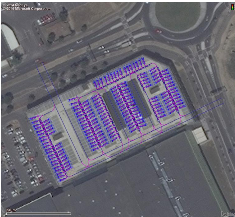
Slika 58: Tloris cestnega omrežja s parkirnimi mesti izdelan v programu Vissim7, na podlagi tlorisov izdelanih v programu Sketchup in grafičnih podlag integriranih v programu Vissim 7 (posnetki iz zraka) [16].
