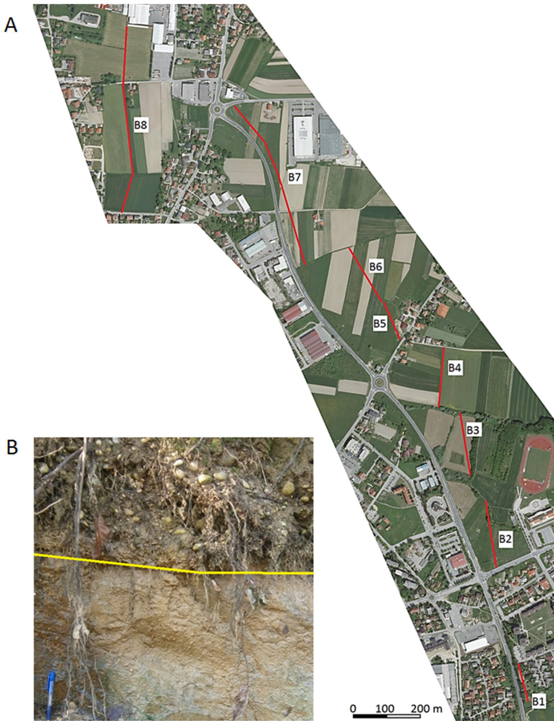
Slika 6.51: A – lokacije georadarskih profilov B1 do B8, posnetih vzdolž Brežičke terase; B – meja med prodrom brežičke aloformacije zgoraj in miocenskim laporovcem spodaj (rumena linija).
