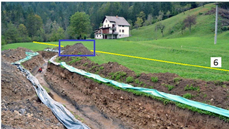
Slika 6.11: Trasa georadarskega profila 6 paleoseizmološkem izkopu je potekala mimo odkopanega materiala (modri okvir), ki je povzročil zračne odboje (po Bavec et al., 2012b).
