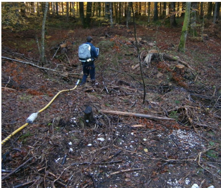
Slika 7.13: Na neravnem terenu se je antena zatikala v veje in korenine, kar je povzročilo njen slabši stik s tlemi.
