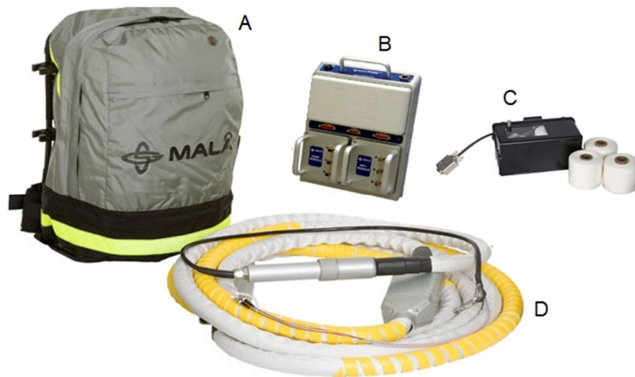
Slika 5.1: Uporabljena georadarska oprema. A – nahrbtnik; B – ProEx kontrolna enota z optičnim modulom antene; C – merilnik razdalje («Hip Chain») z bombažno vrvico; D – RTA antena (Mala, 2014).
