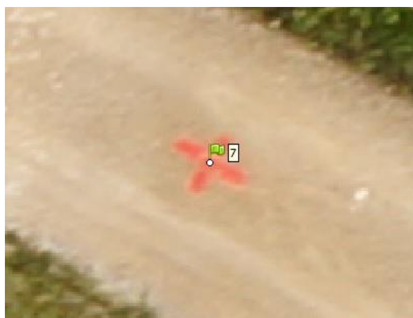
Slika 12: Prikaz postavitve zastavice v programu Agisoft Photoscan Pro na signalizirano točko 7
