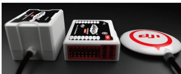
Slika 2: Inercialna merska enota, glavni regulator krmilnega sistema in GNSS sprejemnik [6]
