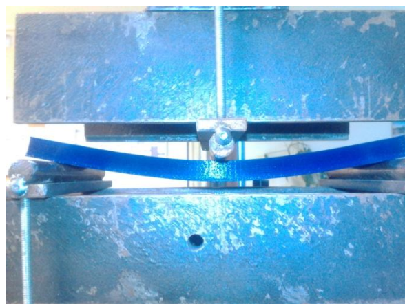
Slika 32: Upogibni preizkus malo pred porušitvijo
