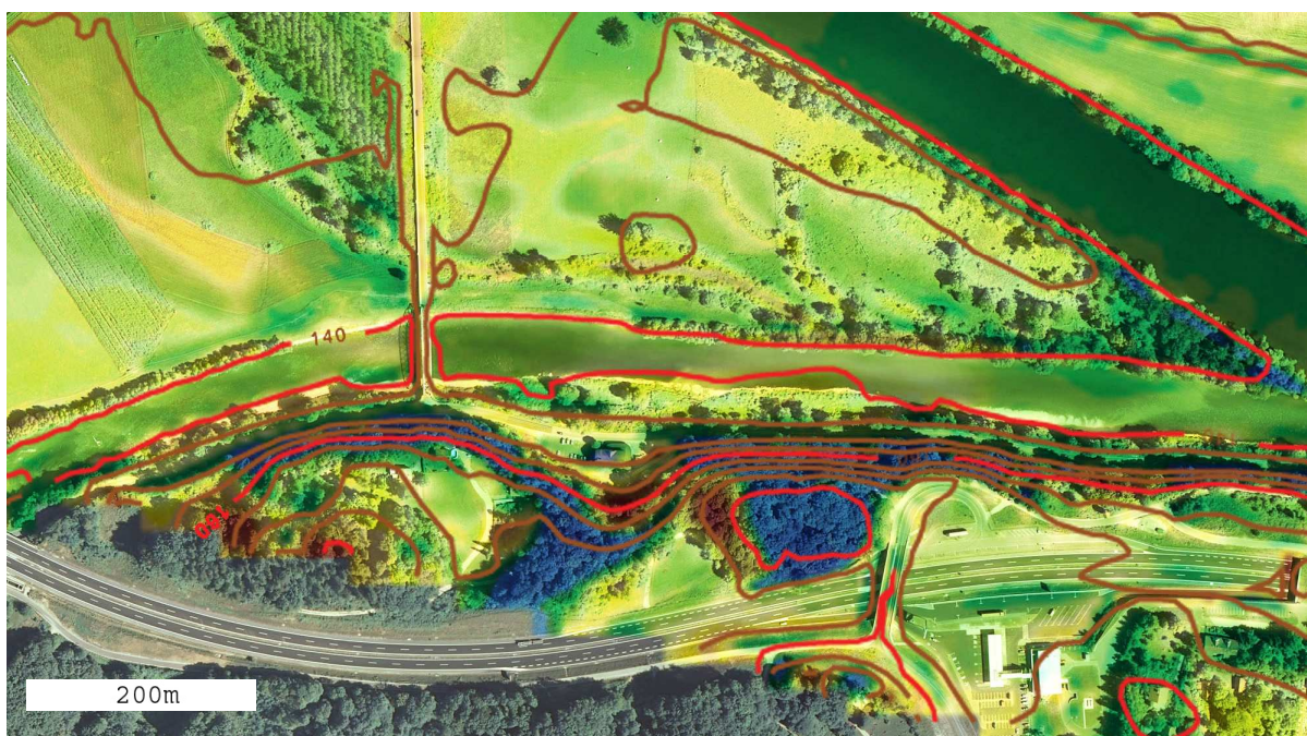
Slika 6-8: Prikaz ortofota, prekrita s hipsometričnim prikazom odstopanj DMV 5 od refDMV s plastnicami.
