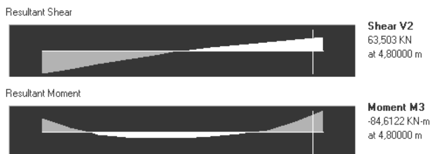
Slika 67 – Redukcija negativnega momenta nad podporo
