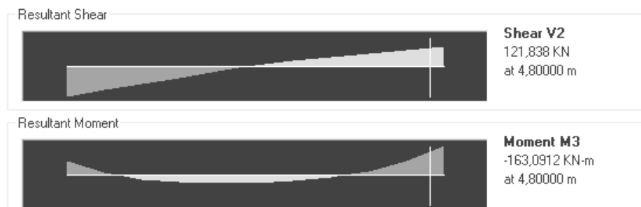
Slika 62 – Redukcija negativnega momenta nad podporo
