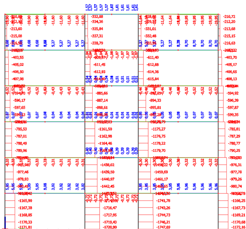
Slika 66: [N] – osne sile gravitacijskega dela seizmičnega projektne stanja v osi 4-4
