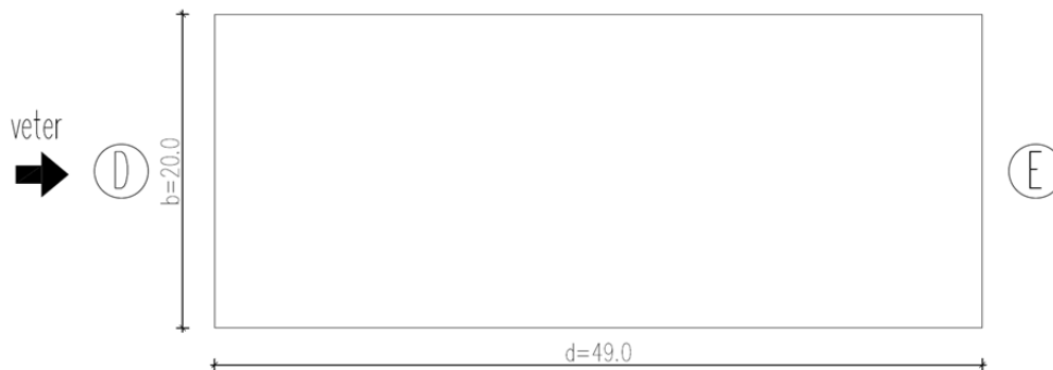
Slika 16: Prikaz cone delovanja vetra D in E glede na tloris objekta
