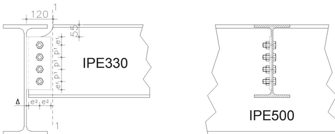
Slika 96: Zasnova členkastega spoja
