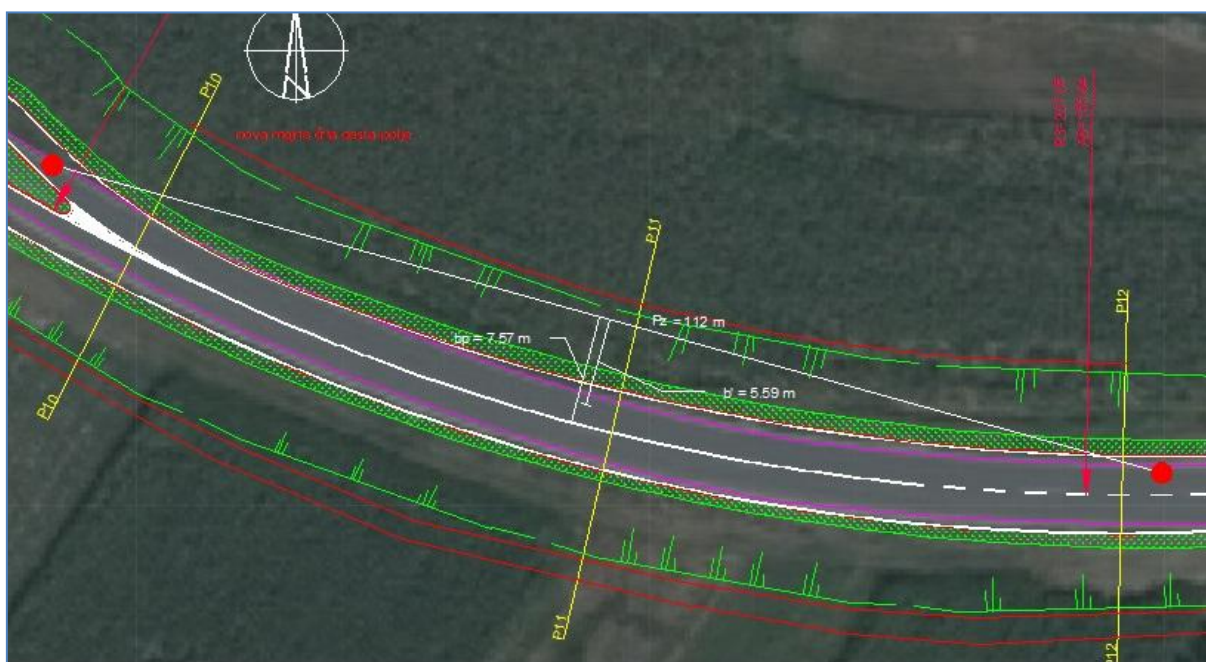
Slika 29: ustreznost preglednostne razdalje krivine R3 nove trase
