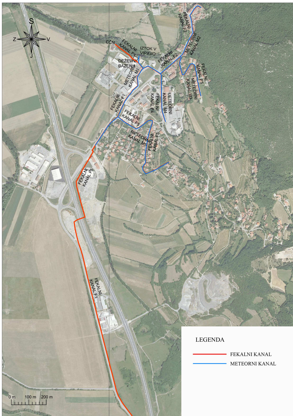
Slika 20: Prikaz zasnove kanalizacijske mreže pri varianti A.
