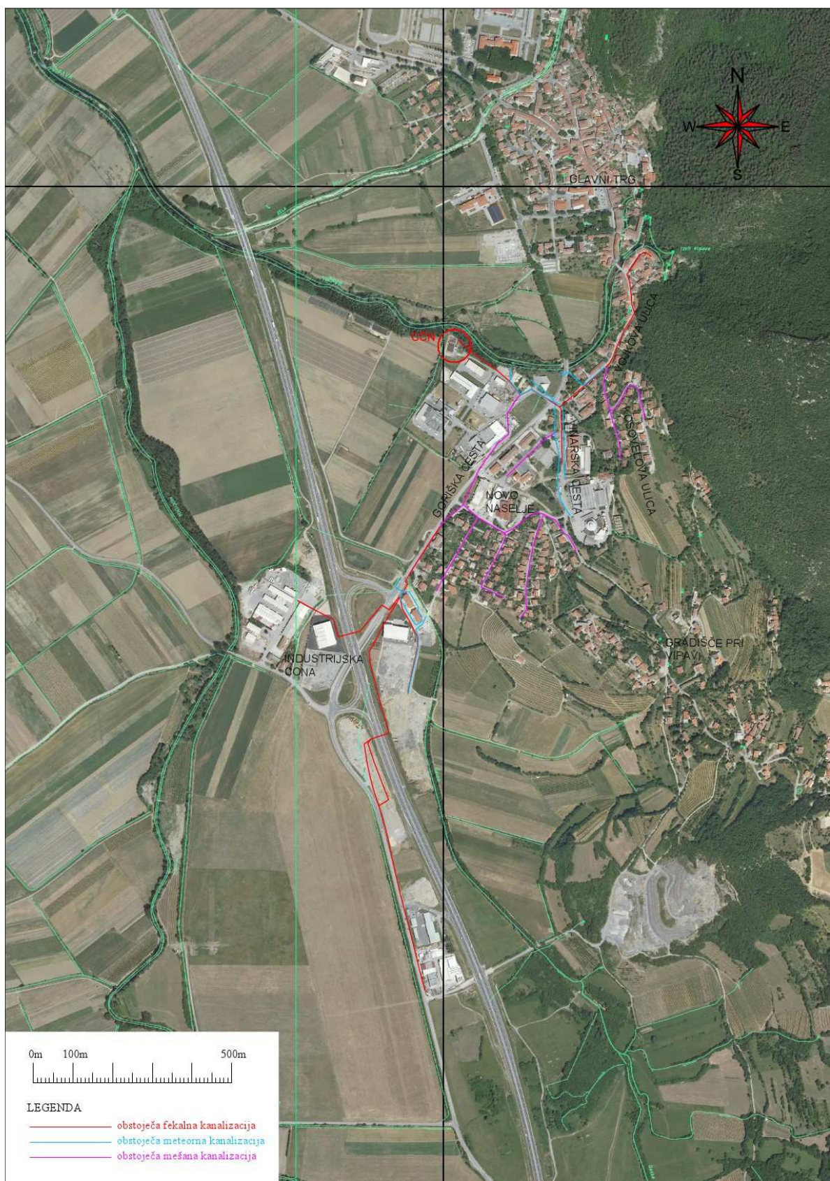
Slika 12: Prikaz obstoječe kanalizacije na obravnavanem območju.
