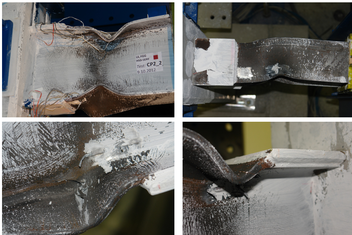
Fig. 37: Specimen CP2.2 after the test Slika 37: Preizkušaneec CP2.2 po končanem testu
