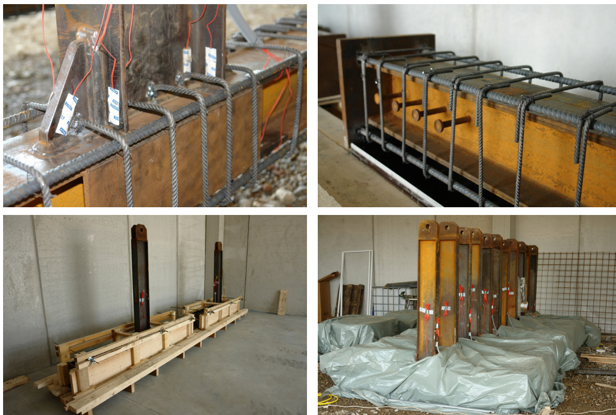
Fig. 20: Final preparation on the test specimens – composition of composite column Slika 20: Zadnja faza priprave preizkušancev – izdelava sovprežnih stebrov
