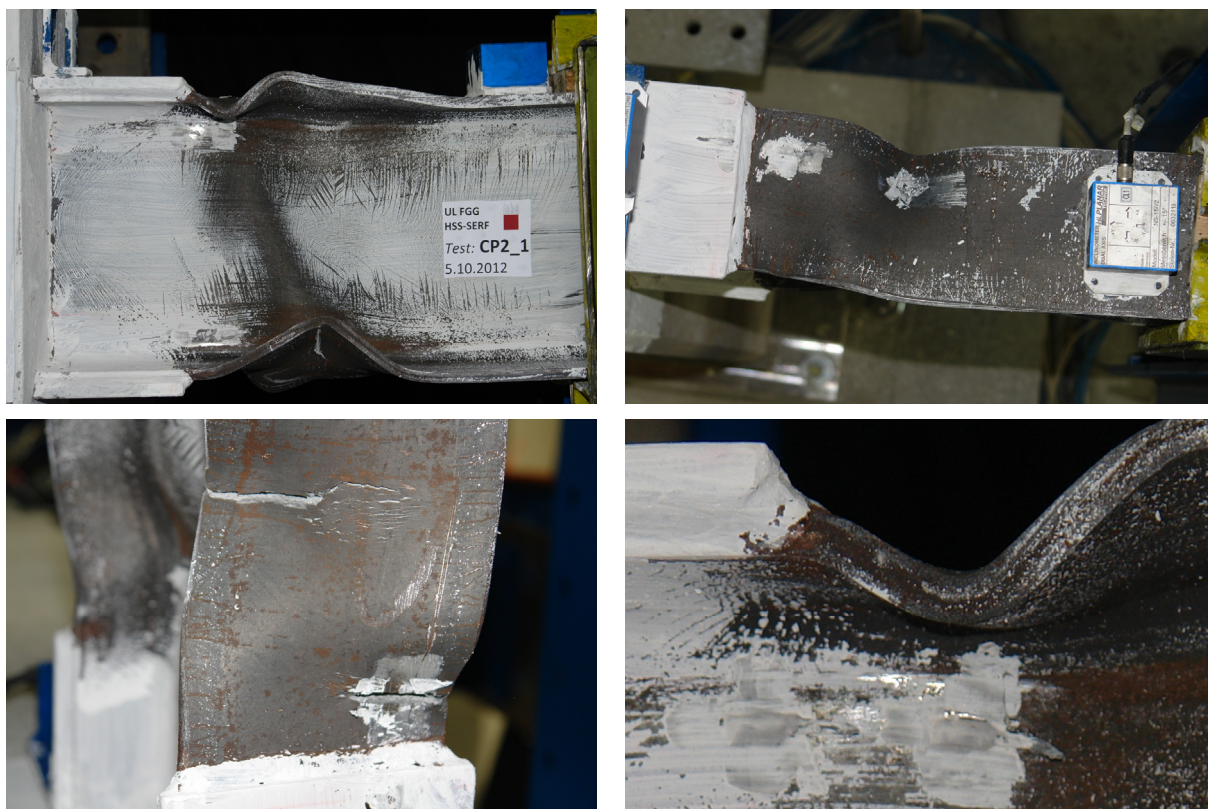
Fig. 36: Specimen CP2.1 after the test Slika 36: Preizkušavec CP2.1 po končanem testu
