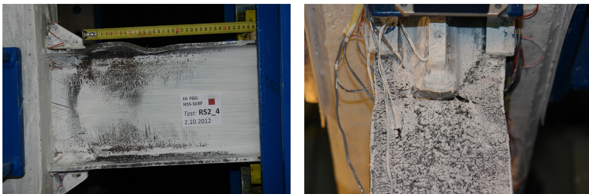
Slika 19: Preizkušavec RS2.4 po končanem testu: a) lokalno plastificirana prečka takoj za koncem ojačanega dela b) frakcija zgornje pasnice
