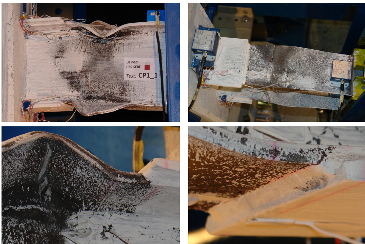
Fig. 34: Specimen CP1.1 after the test Slika 34: Preizkušavec CP1.1 po končanem testu
