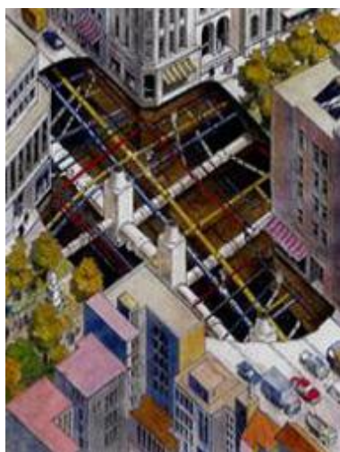
Slika 2: Prikaz podzemnih komunalnih vodov, [1]
