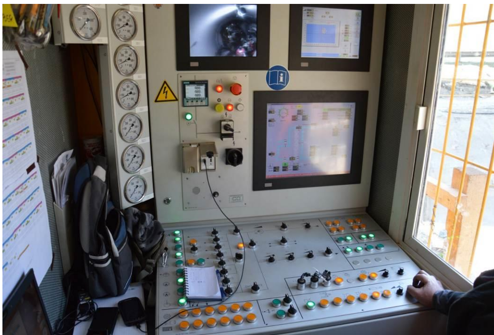
Slika 58: Računalniška konzola za vodenje in spremljanje vrtanja, [lasten arhiv]
