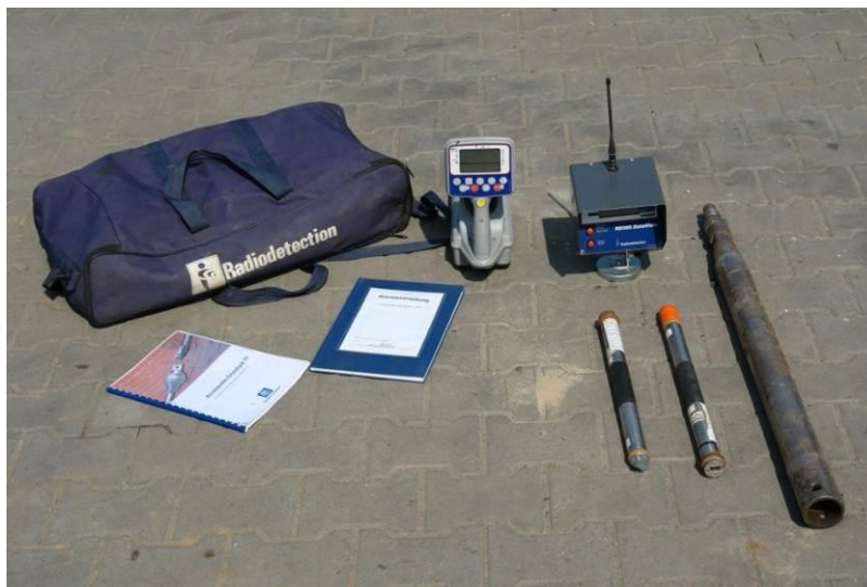
Slika 43: Oprema za radijsko vodenje vrtalne glave, [22]
