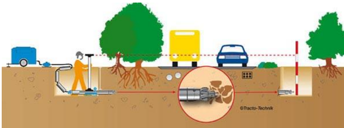
Slika 16: Shema preboja s pnevmatsko iglo, [8]
