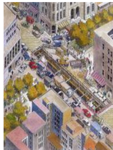
Slika 3: Primer delovišča z izvedbo klasičnega izkopa, [1]
