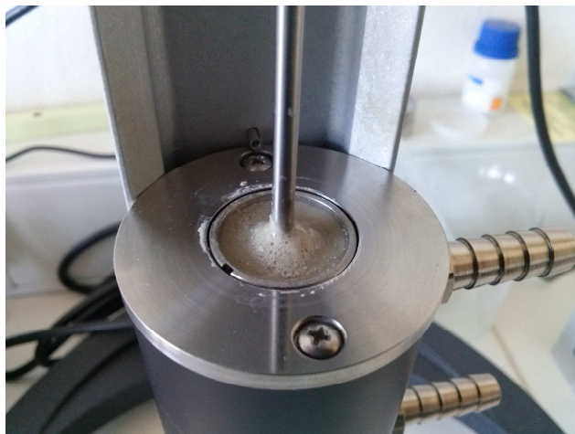
Slika 10: Kalup reometra s sondo in preizkušancem
