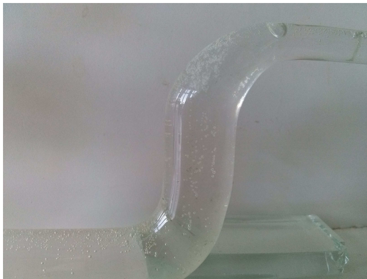
Slika 17: Pojav mehurčkov v Enslinovem aparatu zaradi kemične reakcije v prašku referenčne zalivne mase
