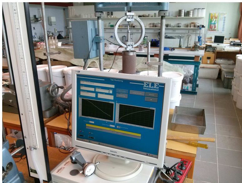
Slika 15: Merilna oprema za potrebe enoosnega tlačnega preskusa
