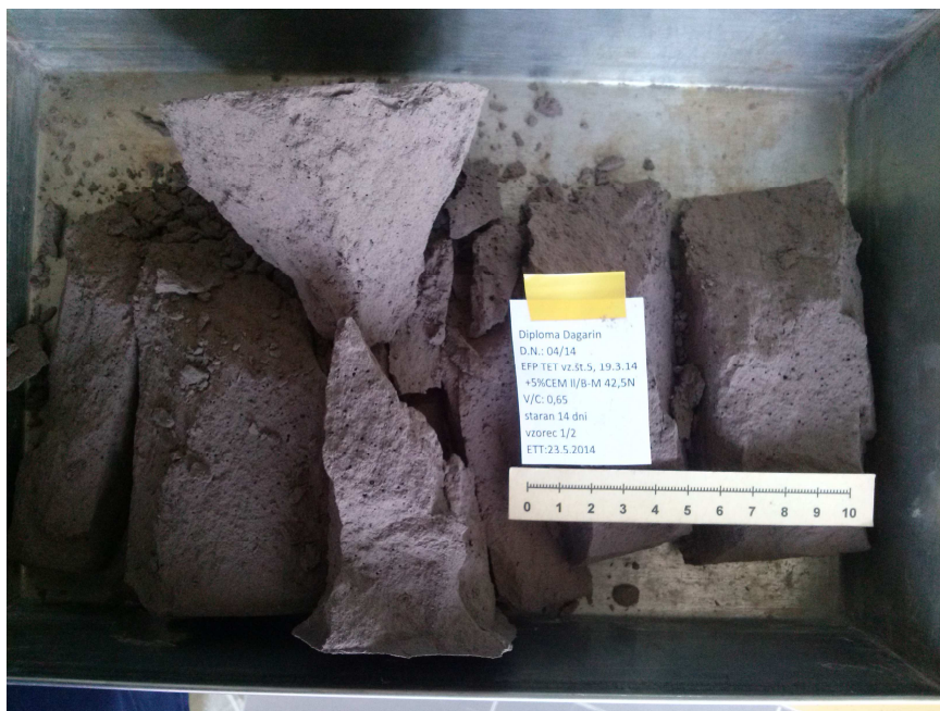
Slika 19: Porušitev po obliki peščene ure
