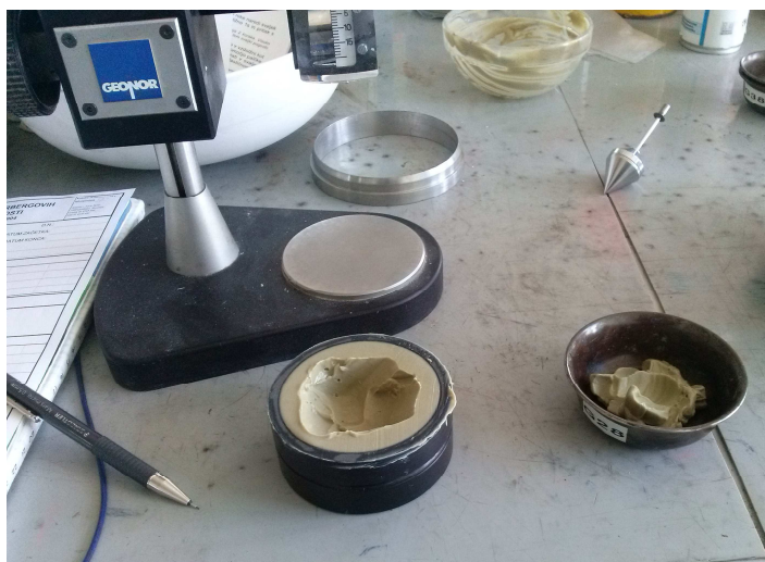
Slika 6: Posodica z vzorcem za izvajanje preskusa (levo) in posodica za določanje vlage (desno)
