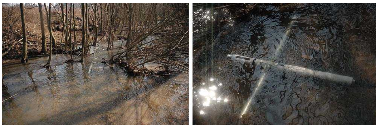
Slika 4.22: Umestitev Hydrolab Datasonder v zadrževalnik – merska točka 9
