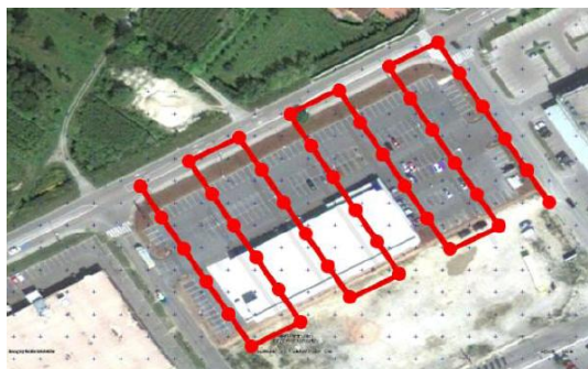
Slika 2.12: Projektiranje aerofotogrametrične izmere (Peterman, Mesarič, 2012: str 448).
