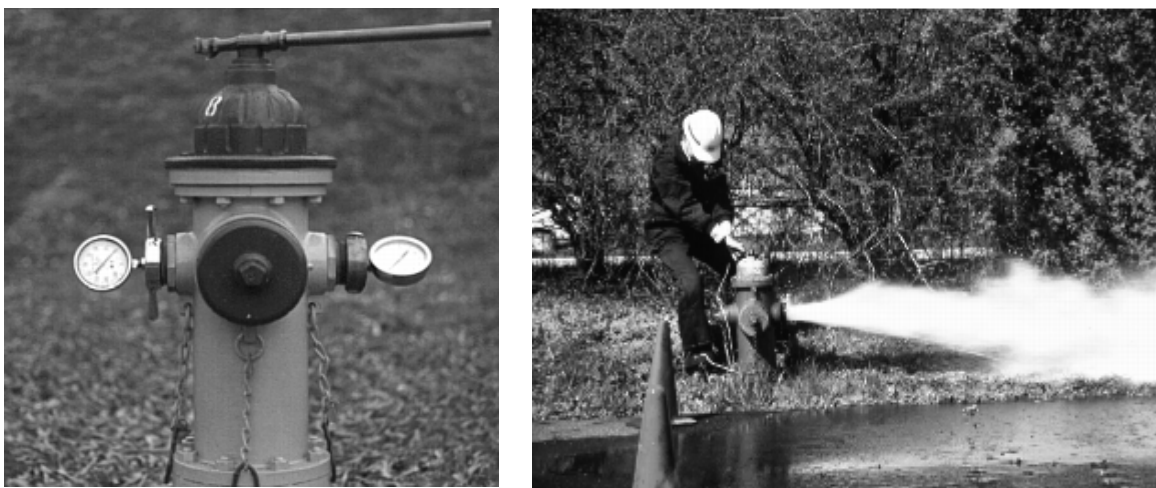
Slika 4.1 Meritev tlaka na hidrantu in izpust pri izvedbi požarnega preizkusa (Walski in sod., 2003)
