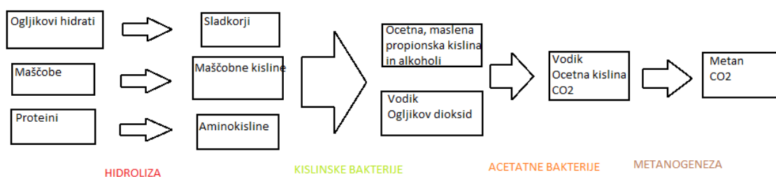
Slika 13: Proces anaerobne presnove po fazah
