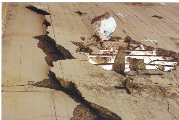
Slika 27: Tipični preboj na mostnem krovu
