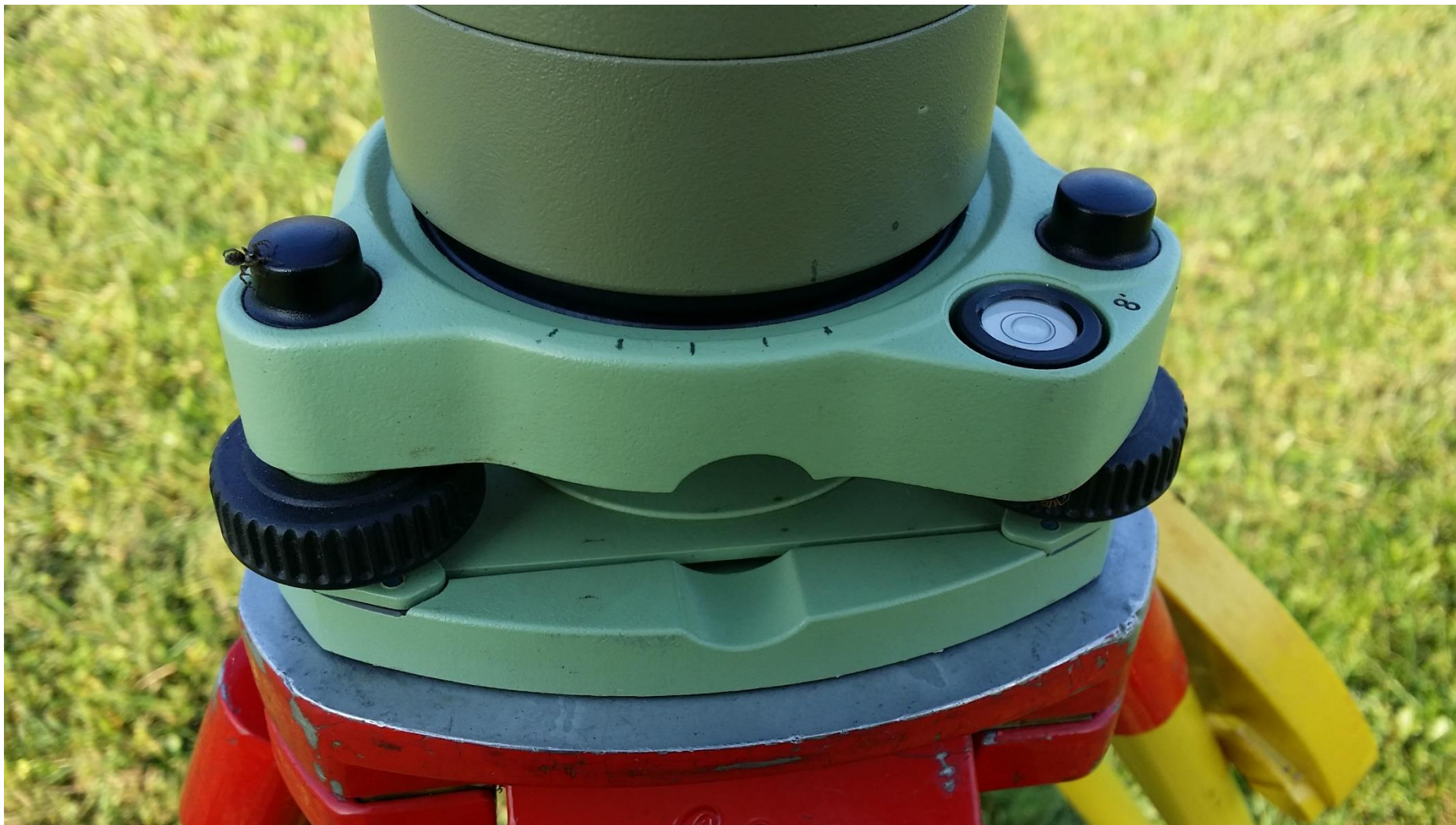
Slika 28: Prikaz razdelbe za določitev kota zamika
