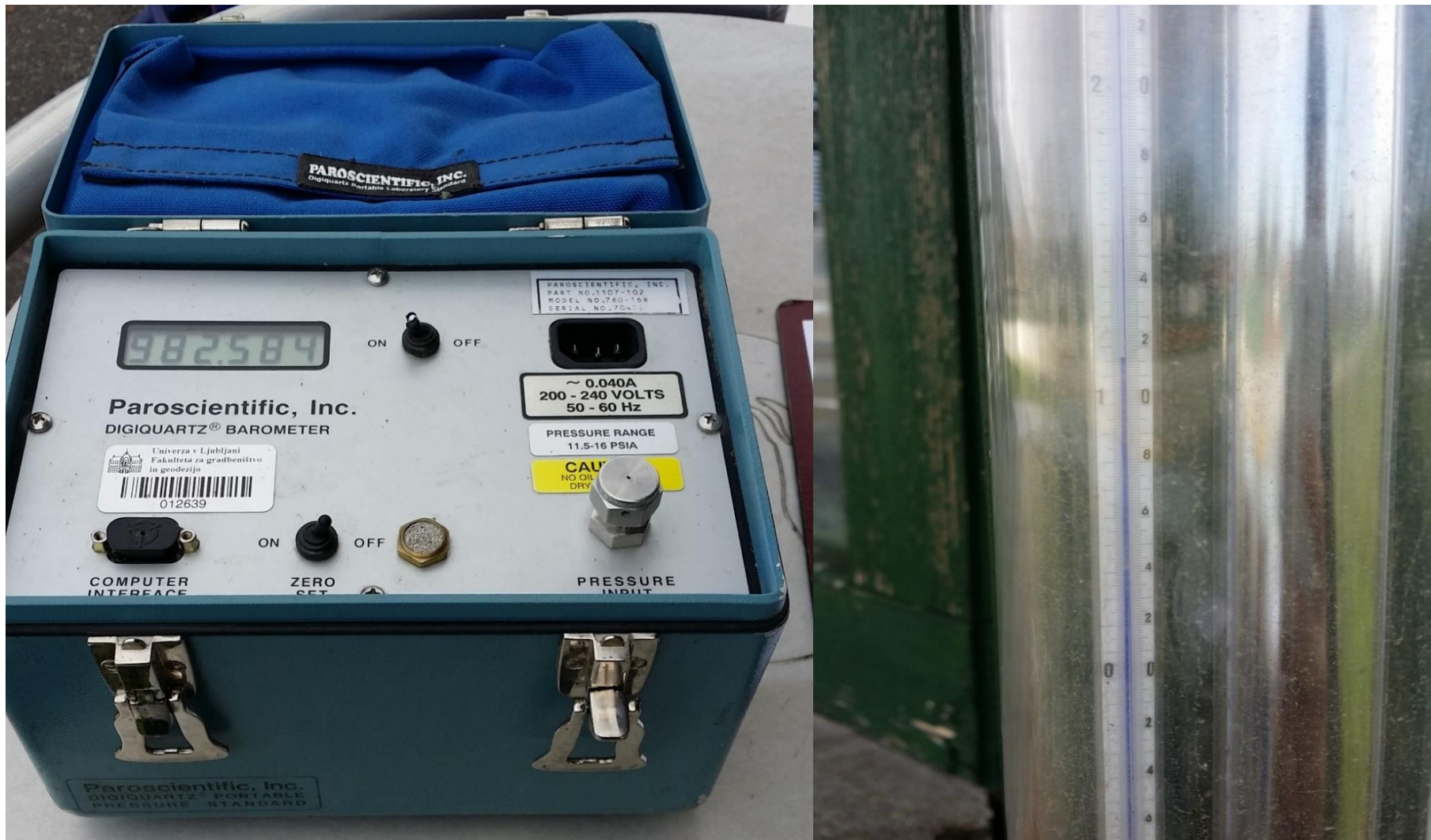
Slika 34: Naprava za merjenje zračnega tlaka (barometer - levo) in termometer za merjenje suhe in mokre temperatur (desno)
