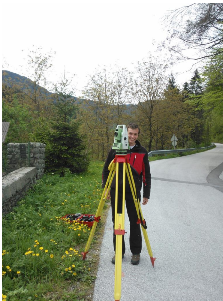
Slika 18: Meritve detajla za geodetski načrt
