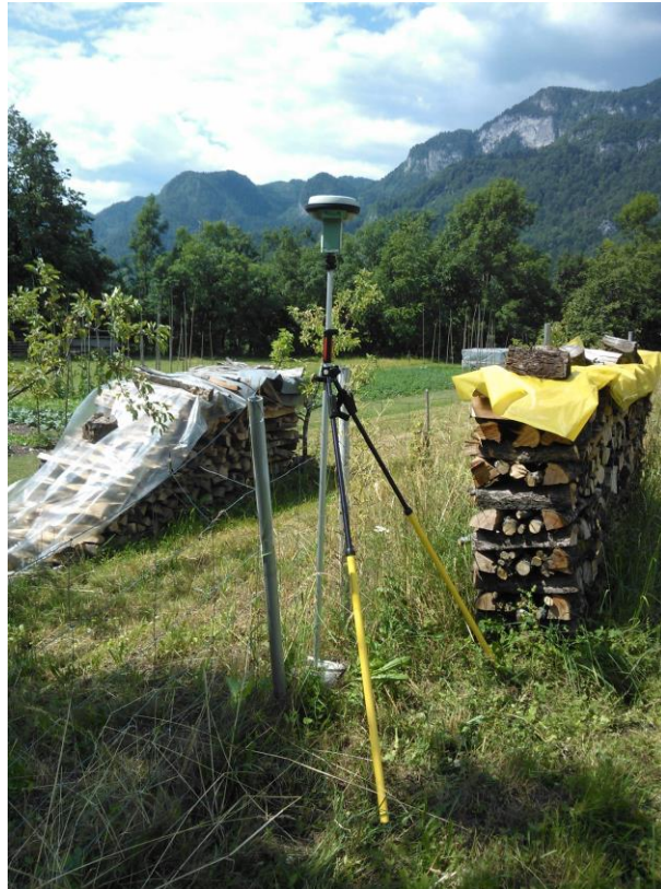
Slika 15: Izmera koordinat točke s pomočjo statične metode GNSS
