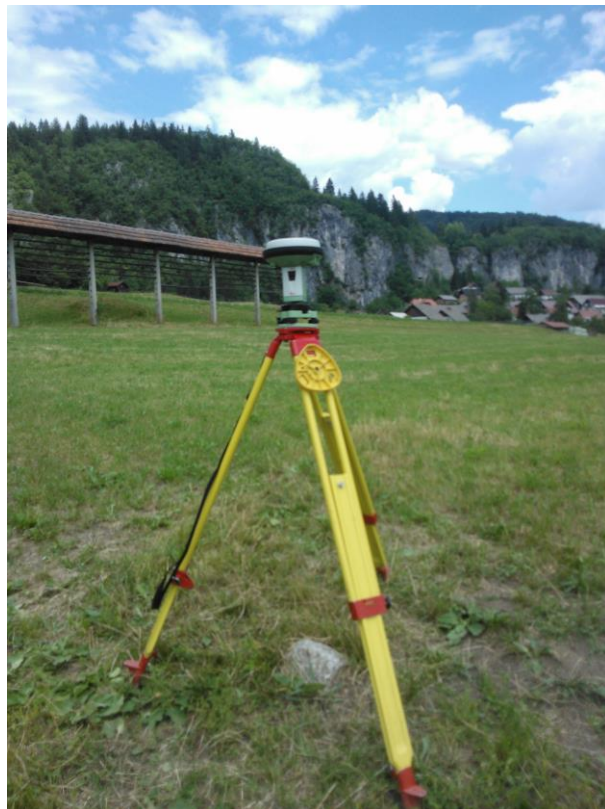
Slika 16: Izmera koordinat točke s pomočjo statične metode GNSS
