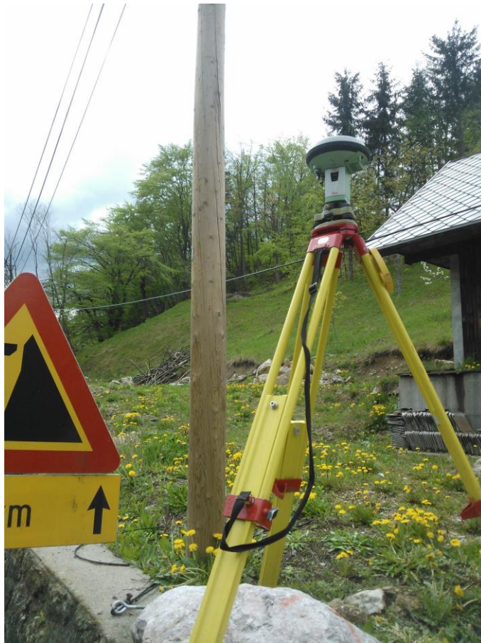
Slika 24: Izmera s statično metodo GNSS na točki MC
