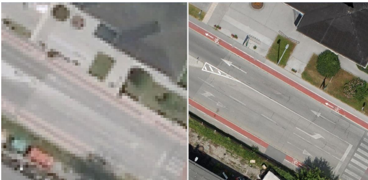
Slika 17: Primerjava državnega ortofota (desno) in izdelanega ortofota iz posnetkov letalnika (levo)
