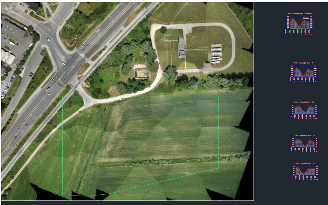
Slika 16: Ustvarjanje profilov melioracijskega jarka v programskem paketu AutoCAD
