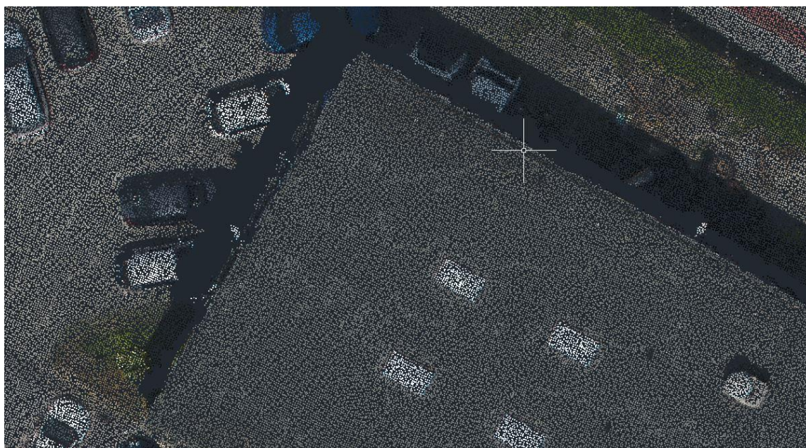
Slika 21: Nejasen potek robov strehe v oblaku točk
