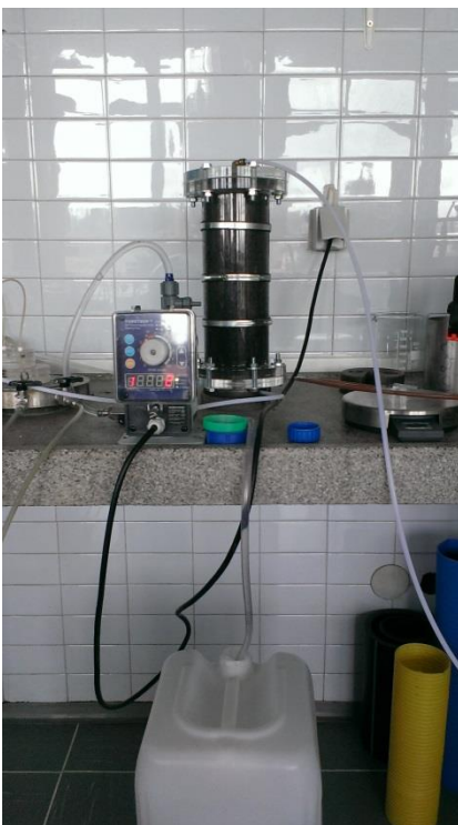
Slika 1c: Posnetek perkolacijskega testa
