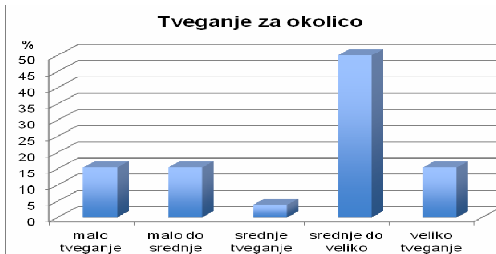
Grafikon 10: Porazdelitev ocene tveganja v skupini tveganje za okolico za 26 hudourniških pregrad na hudourniških pritokih Save Dolinke.
