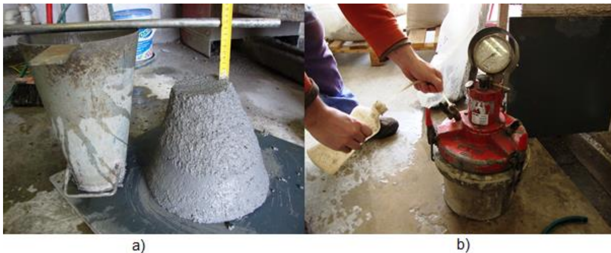
Slika 37: Merjenje poseda a) in določanje vsebnosti zraka b)
