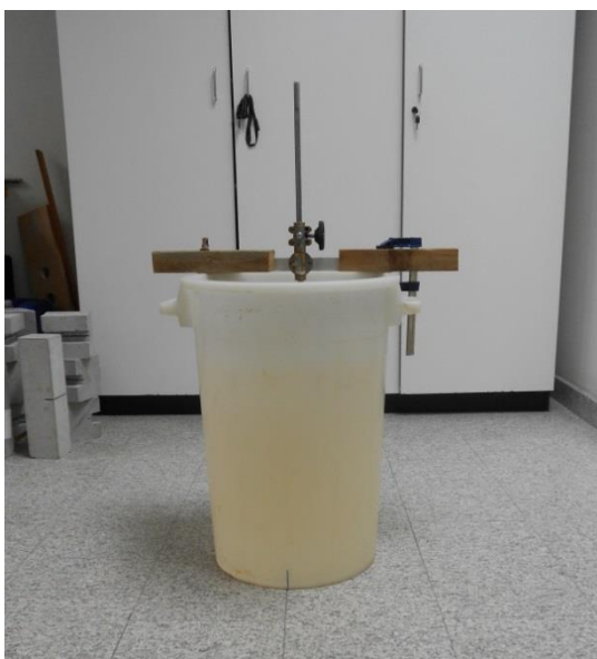
Slika 47: Prikaz pripomočkov za izvedbo postopka določanja obrabe preskušancev po metodi z merjenjem spremembe vodne gladine v posodi
