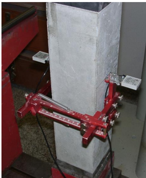
Slika 40: Prikaz namestitve merilne opreme na preskušane
