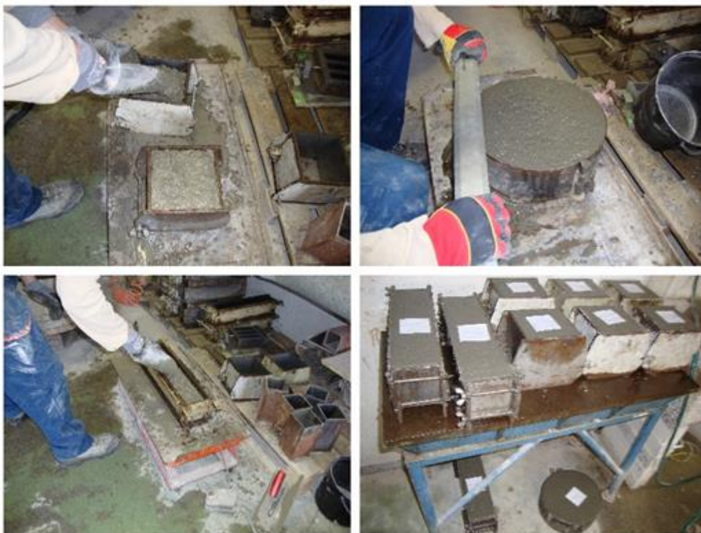
Slika 36: Vgrajevanje svežega betona v kalupe
