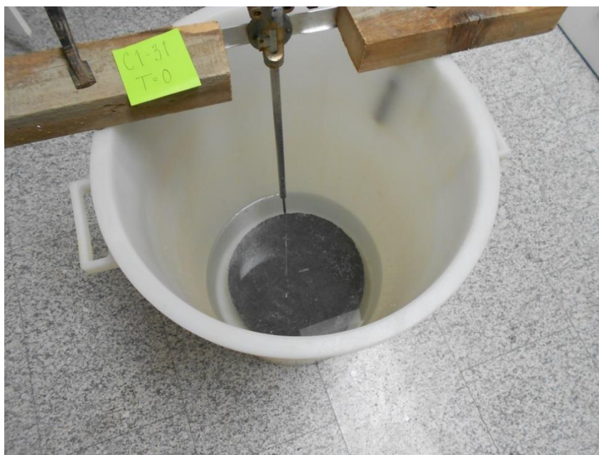
Slika 48: Prikaz merjenja višine gladine vode v posodi s preskušancem
