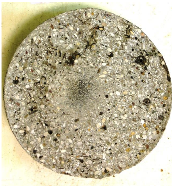
Slika 43: Prikaz stopnje razvitosti abrazijske erozije na preskušancu po opravljenem preskusu ASTM C 1138
