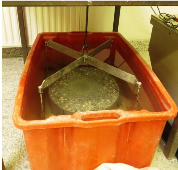
Slika 44: Preskušane med tehtanjem v vodi
