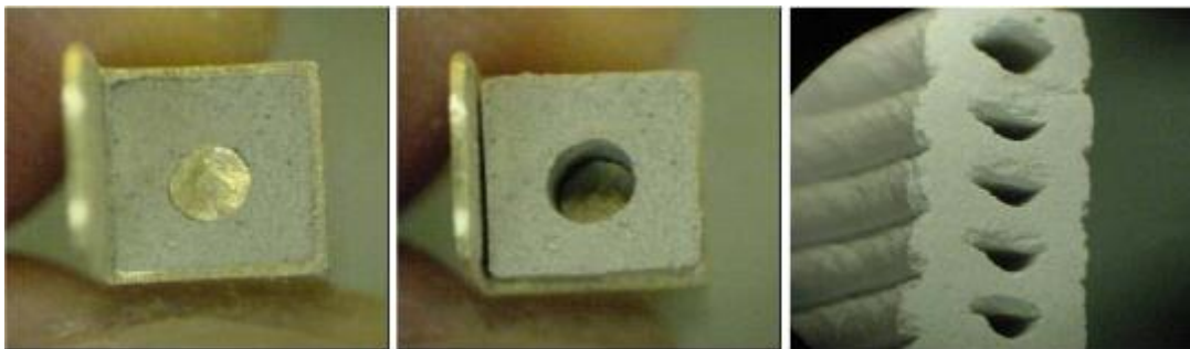
Slika 68: Primer šobe za izdelavo niti s tehnologijo CC (Khoshnevis, 2004, str. 8)
