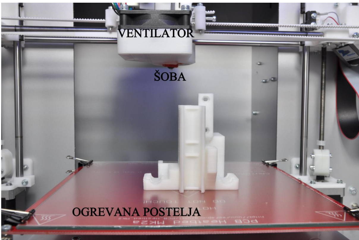
Slika 13: Prikaz deformiranih plasti kot posledica izklopljenega hlajenja
