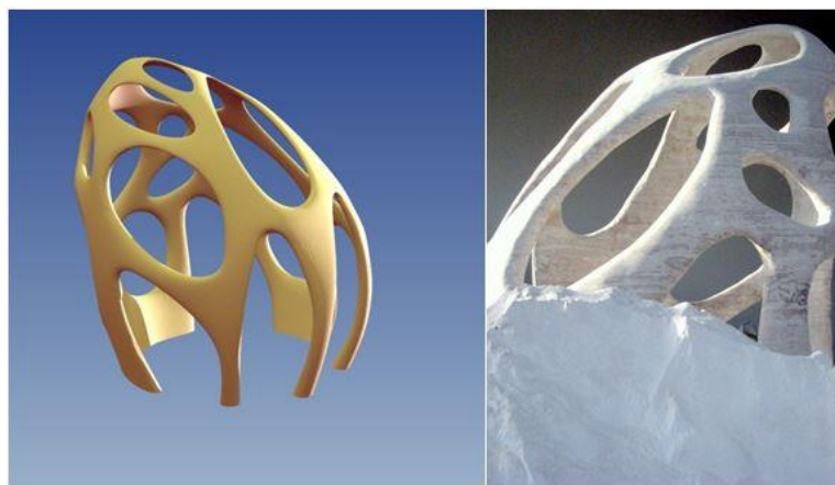
Slika 74: 3D-model radiolarije londonskega arhitekta Andrea Morganteja in 3D-objekt, izdelan s tehnologijo d_shape (d-shape, 2014)
