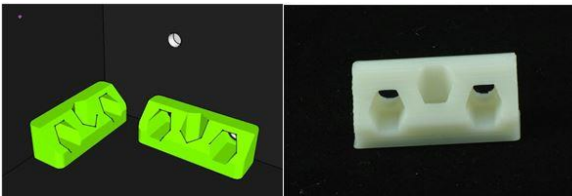
Slika 48: Model pritrdilnih elementov, izdelan v programu SketchUp 8, in 3D-natisnjen element
