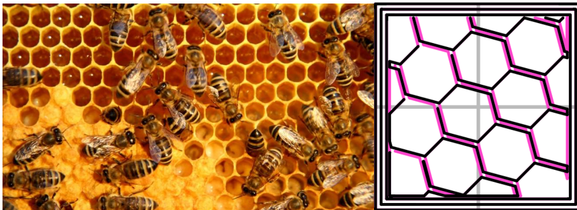
Slika 51: satovje, ki ga ustvarijo čebele (Krulwich, 2013) in satovje, ki ga kot polnilo ustvari program Slic3r
