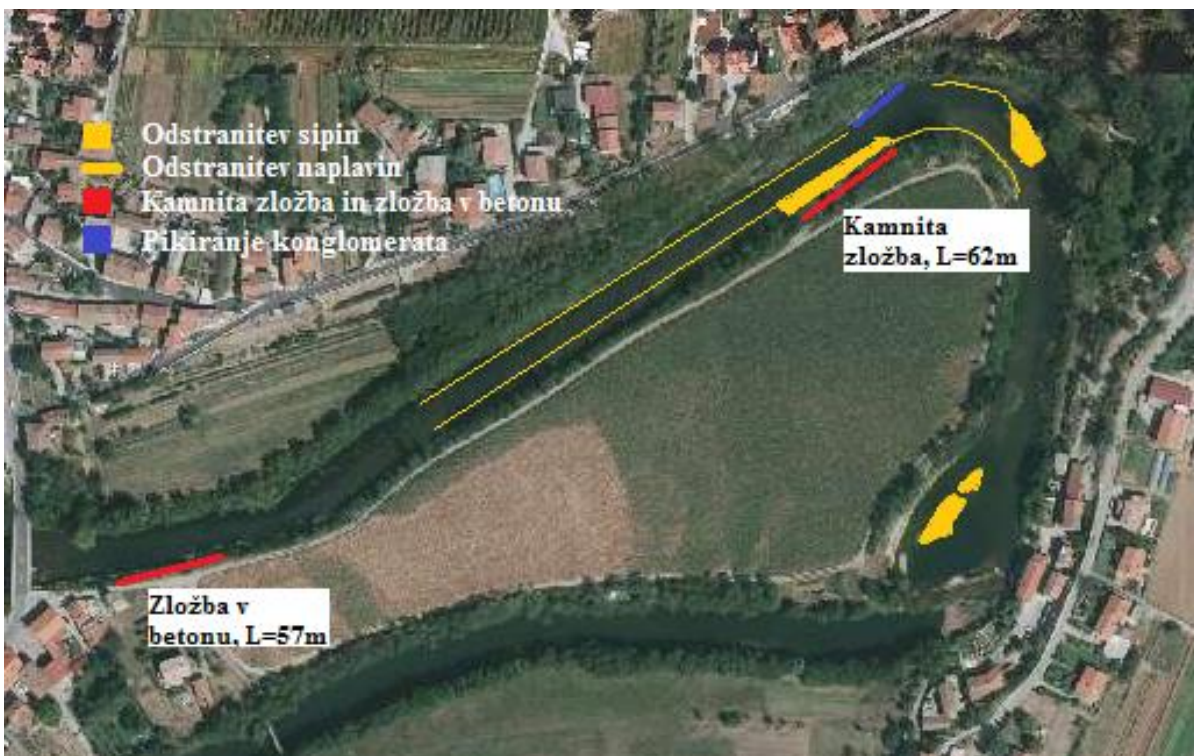
Slika 22: Območje sanacijskega programa gorvodno od mostu do jezua v Orehovljah (Piso, 2014)
