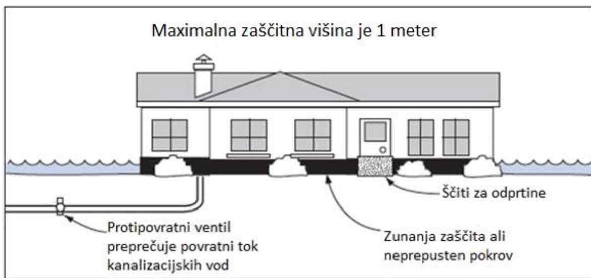
Slika 6: Tipična hiša zaščitena s suhim tesnjenjem (Fema, 2009c)
