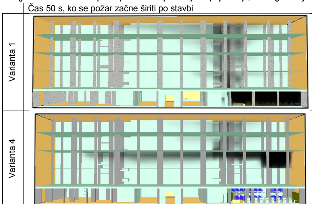
Preglednica 8-11: Grafični prikaz poteka dima pri 50 s po odprtju luknje, ki omogoča širjenje požara
