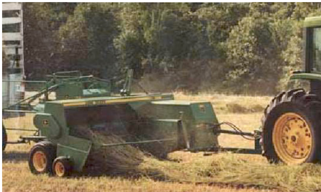
Slika 2.2: Stroj za izdelavo majhnih bal slame dimenzije 35x50x100 cm.
