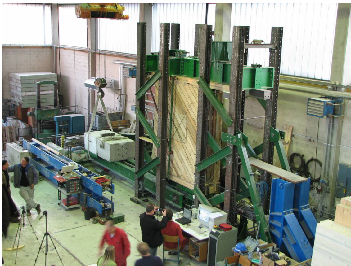
Slika 6.4: Preizkušanec v napravi za preizkušanje strižne nosilnosti stenskih elementov.
