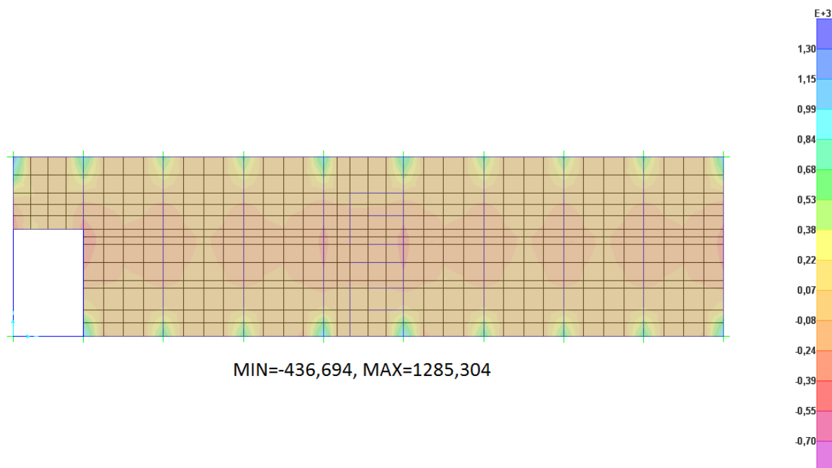
Slika 31: Ovojnica maksimalnih projektnih osnih sil f_{22} v obravnavani medetažni plošči (SAP2000, Computers and Structures, Inc., 2011)
