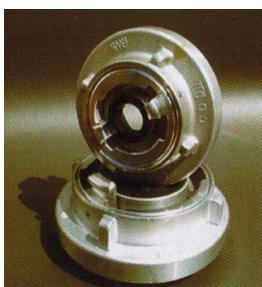
Slika 19: Prehodne spojke (M. Verbič, B. Kovačič, 2004, Tehnika I-IV, str. 70)
