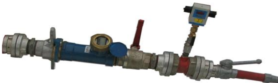
Slika 29: Merilnik pretoka - ustnik \Phi 52 zgoraj in ustnik \Phi 20 spodaj, kjer je viden tudi merilnik tlaka (Vir: Javo podjetje Vodovod- Kanalizacija Ljubljana)
