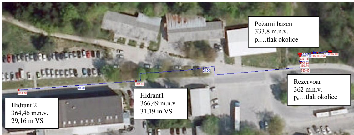
Slika 34: Prikaz nadmorske višine, ter tlaka na elementih v sistemu.
